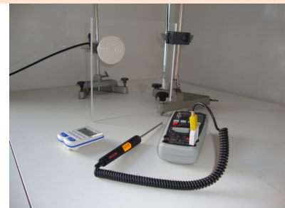
Abb.: Acrylglasplatte vor der Infrarotlampe
