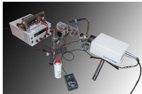
Abb.: Messaufbau Thermokamera mit Küvette und Temperaturquelle.
