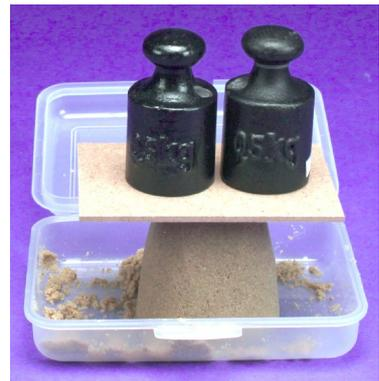
**3. Sandturm, geschichtet gedrückt, mit Gewebe:** Der Becher wird erneut schichtweise mit Sand befüllt. Nach jeder Schicht wird nun zusätzlich ein Armierungsgewebe eingelegt und der Sand festgedrückt (wie bei 2.). Am Ende sollten für einen Turm ungefähr zehn dieser Schichten entstehen; den Becher umdrehen und abheben. Dieser Turm ist durch die hohe Verdichtung und Verstärkung schwierig aus dem Becher zu bekommen. Mehrfaches Klopfen und leichtes Zusammendrücken des Bechers hilft hier.
