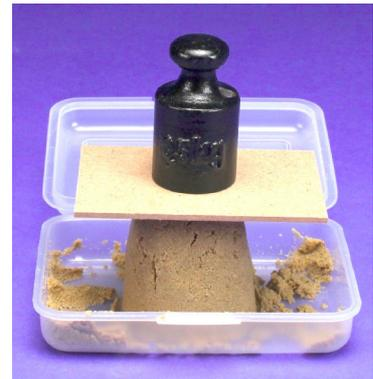
**2. Sandturm, geschichtet gedrückt:** Der Becher wird schichtweise mit Sand befüllt, und nach jeder Schicht wird mit dem zweiten Becher der Sand festgedrückt. Am Ende sollten für einen Turm ungefähr zehn dieser Schichten festgedrückt werden. den Becher umdrehen und abheben.
