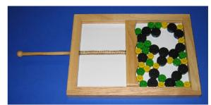
**Trichter** – Die Ausbildung von Kraftbrücken erklärt auch, warum Granulate in Trichtern oder Röhren verstopfen können. Ist der Trichter erst verstopft hilft es wenig von oben nachzudrücken, weil die Kraftbrücken solche Belastungen gut aufnehmen können. Hilfreicher ist es die Kraftbrückenausbildung zu stören, indem z. B. seitlich an den Trichter geklopft wird.
