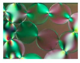
scheiben sind Stücke eines 2 mm dicken PVC-Streifenvorhangs (auch bekannt als Lamellenvorhang), der meist in Industriehallen eingesetzt wird. Online können wenige Meter (bei 20 cm Breite) bereits für ca. 10,- Euro inkl. Versand bestellt werden (vgl. Materialliste). Das Material lässt sich problemlos mit einer Schere zuschneiden.
