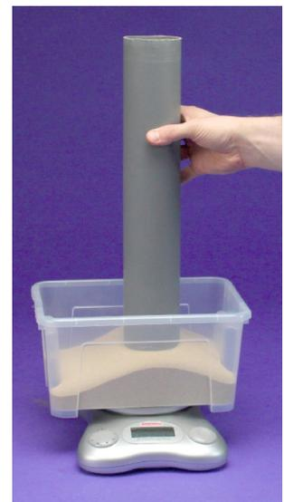
**Rohr bewegen:** Dann kann das Rohr leicht angehoben werden und beobachtet werden, wie sich die Anzeige der Waage verändert. Dabei kann gespürt werden, wie viel Widerstand das Rohr dem Sand entgegengesetzt. Zum Abschluss sollte das Rohr komplett entleert werden und die Gesamtmasse des Sandes gemessen werden.
