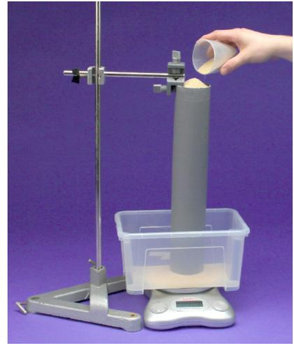
**Rohr lösen:** Die Doppelmuffe am Rohr wird gelöst und das Stativmaterial entfernt, sodass das Rohr komplett auf der Waage steht. Am Ende: Masse ablesen und notieren.
