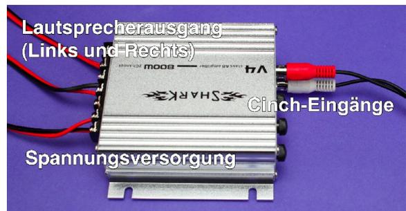
**Spannungsversorgung:** Die Bananenstecker müssen an einer 12 V-Gleichspannungsquelle angeschlossen werden (schwarz an den negativen Pol und rot an den positiven Pol). Eine Unterversorgung mit einer zu niedrigen Spannung ist für den Verstärker ungefährlich, eine Überversorgung mit einer zu hohen Spannung kann den Verstärker beschädigen.
