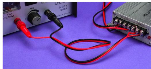
**Lautsprecherverkabelung:** Zwei der roten Steckschuhe müssen an den Steckverbindern am Lautsprecher angebracht werden. Es sind insgesamt vier rote Steckschuhe vorhanden (zwei für den linken Kanal und zwei für den rechten Kanal des Stereo-Verstärkers). Es muss darauf geachtet werden, dass die beiden angeschlossenen Steckschuhe vom gleichen Kanal sind.
