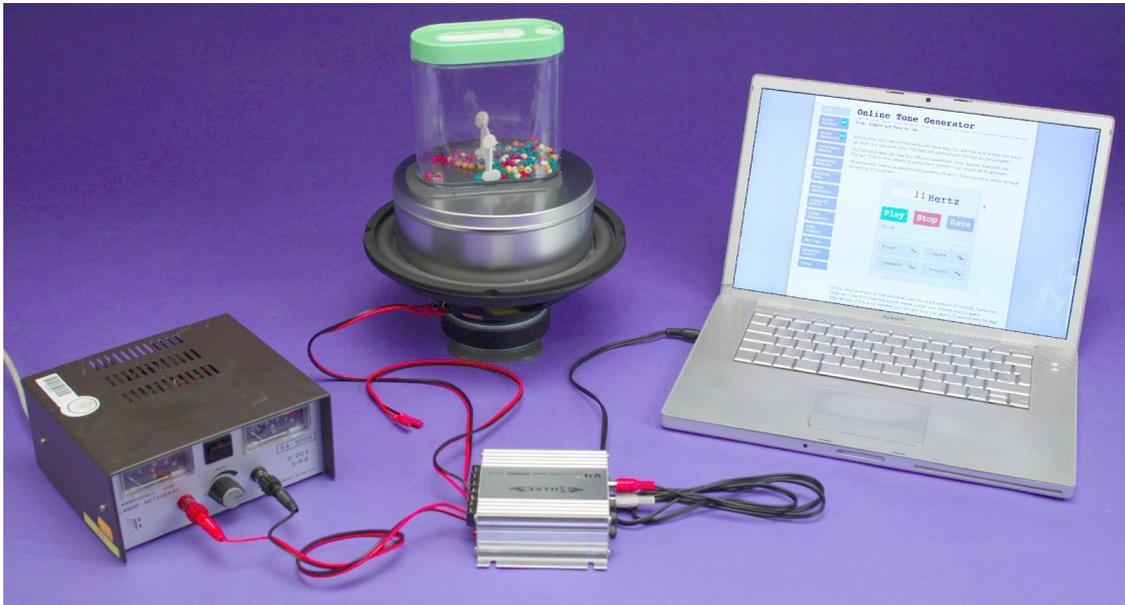
**Verstärker:** Am Verstärker sind bereits Kabel angebracht: a) zur Spannungsversorgung (eine Zwillingsleitung) und b) zum Lautsprecher (je eine Zwillingsleitung für das Signal L (Links) und R (Rechts)). Zusätzlich gibt es zwei Cinch-Eingänge für das Audiosignal.
