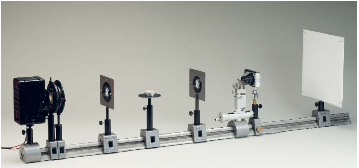
Abb. 7: Klassischer Aufbau nach Töpler mit Diffusor, Schlierenobjekt und Dokumentationskamera.
