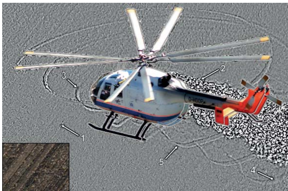
Abb. 14: Turbulenzen um einen Hubschrauber können mithilfe der Moiré-Methode als Schlierenabbildung sichtbar gemacht werden (aus [12]).
