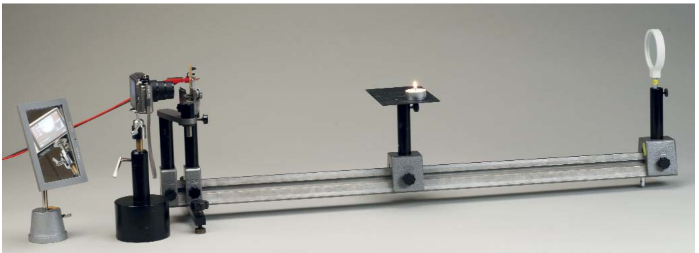
Abb. 5: Foucault-Aufbau ‚low-cost‘ mit preiswertem Spiegel und LED als Punktlichtquelle.
