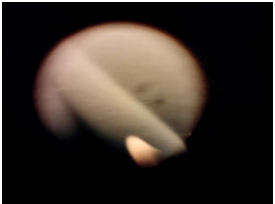
Abb. 8: Abbild eines Schlierenobjekts beim klassischen Aufbau nach Töpler – Flamme eines Teelichts im Luftzug (Ausschnitt aus einem Video gemäß Aufbau aus Abb. 7).
