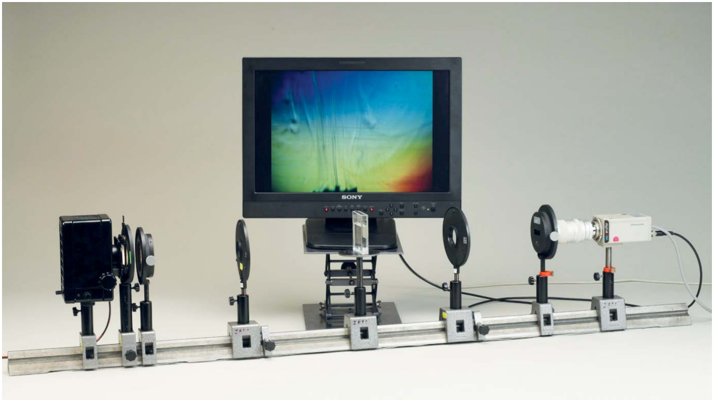
Abb. 12: Liveaufnahme einer Schlierenabbildung mit chromatisch fehlerhaften Linsen (vgl. Abb. 9). Auch hier befindet sich in der wassergefüllten Küvette ein Zuckerwürfel, der sich gerade auflöst. Es werden ebenfalls Linsen mit einer Brennweite von 200 mm verwendet, die beiden Spalte sind horizontal angeordnet.
