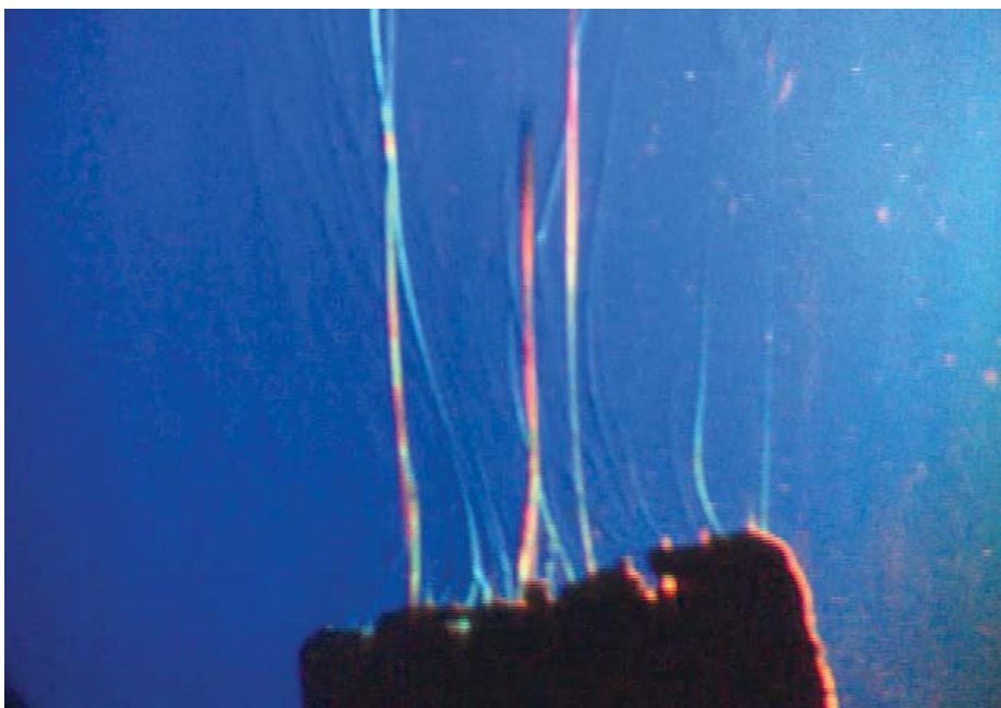
Abb. 11: Schlierenabbildung beim Aufbau nach Schardin – Ausschnitt eines Videos des sich auflösenden Zuckerwürfels (aus Abb. 10).
