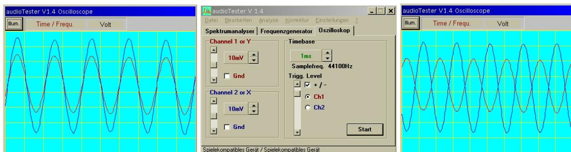
Abb.7: Messung der Schallgeschwindigkeit mit Hilfe der AudioTester-Software anhand der Phasenverschiebung unterschiedlich positionierter Mikrophone.
