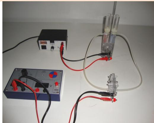
Abb.: Elektrolyse (hinten rechts) und Brennstoffzelle (vorne rechts)
