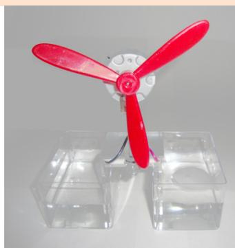
Abb.: Thermogenerator mit kochendem und Eiswasser.
