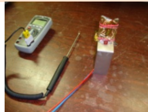
Abb.: Umhülltes Peltier-Element mit metallisierter Folie
