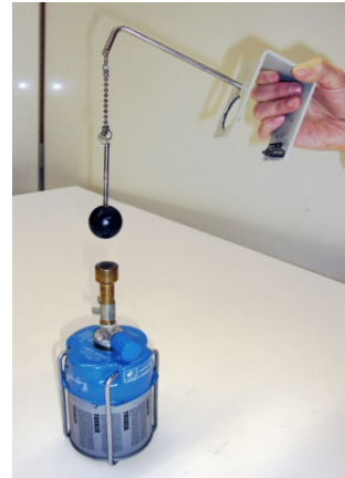
Abb. 97: Kugelfallversuch in Abhängigkeit von der Erwärmung an einem Metallring
