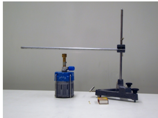
Abb.: Ein Aluminiumstab wird in der Stabmitte erhitzt.
