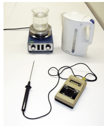
Abb.: Magnetrührer, bei dem die Heizung auf 100 °C eingestellt wird
