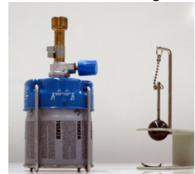
Abb. 97: Kugelfallversuch in Abhängigkeit von der Erwärmung an einem Metallring
