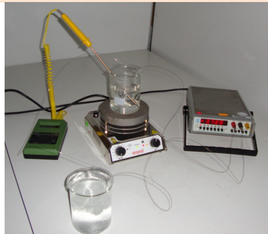
Abb.: Anordnung der Drähte für die Messung der Thermospannung
