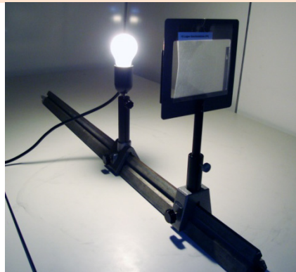
Abb.: Foliensatz zwischen Glühlampe und Wärmebildkamera
