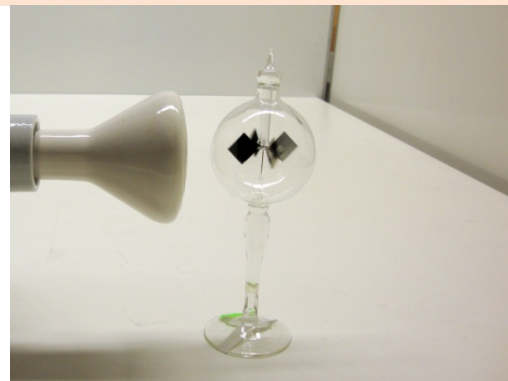
Abb.: Radiometer mit Infrarotstrahler
