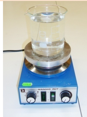
Abb.: Magnetrührer als Heizplatte
