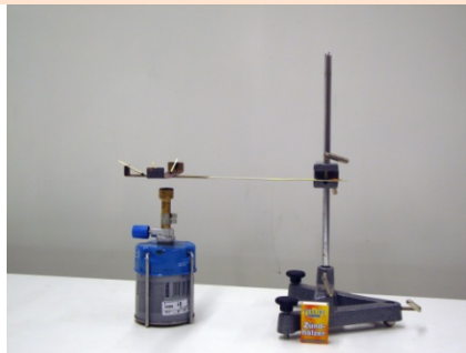
Abb.: Wärmeleitung in unterschiedlichen Metallen
