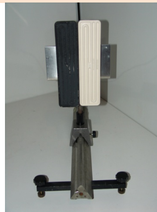
Abb.: Baugleiche Heizstrahler mit schwarzer und weißer Oberfläche
