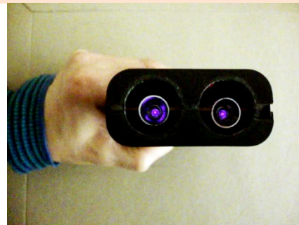
Abb.: IR-Sendendioden im Nahen Infrarotbereich
