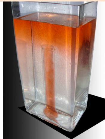
Abb.: Verteilung des heißen Wassers im kalten Wasser
