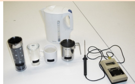
Abb.: Gefäße von links: Isolierbecher, Glas, Porzellan und Stahl
