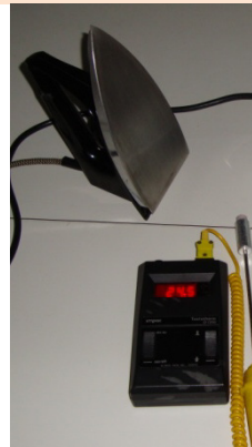
Abb.: Bügeleisen und Temperaturfühler
