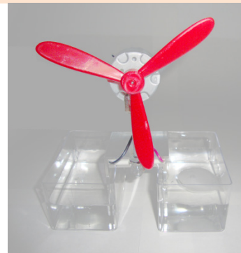
Abb.: Thermogenerator mit kochendem und Eiswasser.
