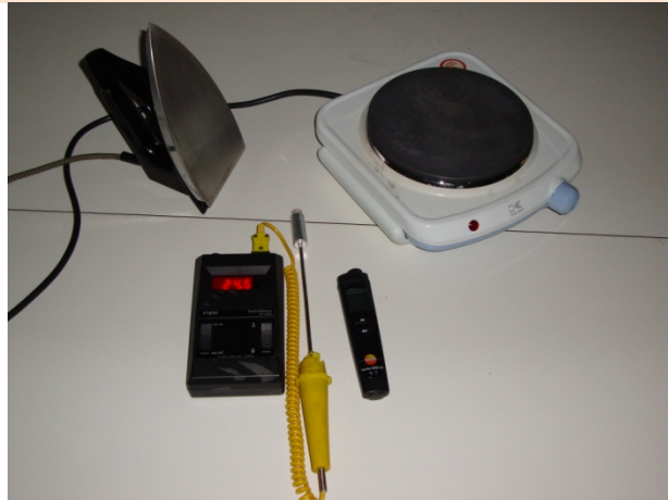
Abb.: Temperaturfühler, Infrarot-Thermometer, Bügeleisen und Herdplatte
